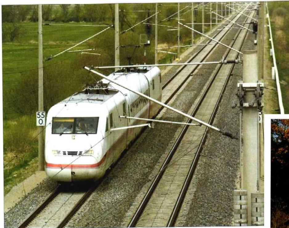
Bild 7: Der Messzug ICE-S auf Abnahmefahrt ABS Hamburg–Berlin mit 253 km/h (Foto: DB / ...)
