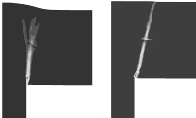
Abb. 13: Bruchfiguren gemäß Mohr-Coulomb- (links) und Shotcrete-Modell (rechts)
